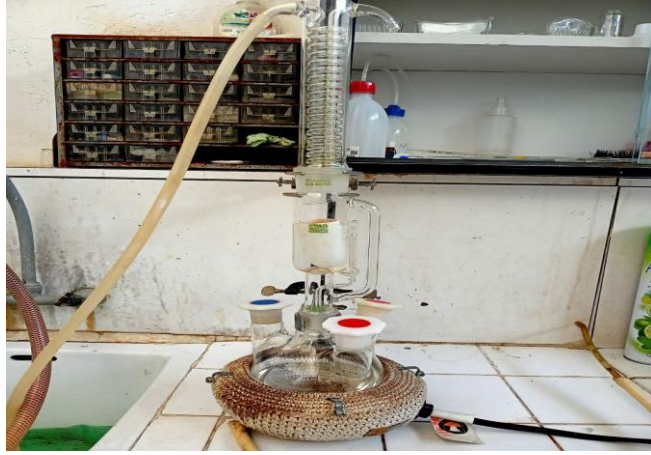
الصورة 6 : صورة لجهاز السوكسلي توضح مكوناته
