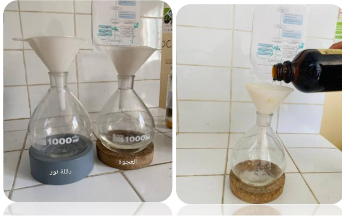
الصورة 7 : صورة ترشيح للمحلول الناتج عن جهاز سوکسلي soxhlet
